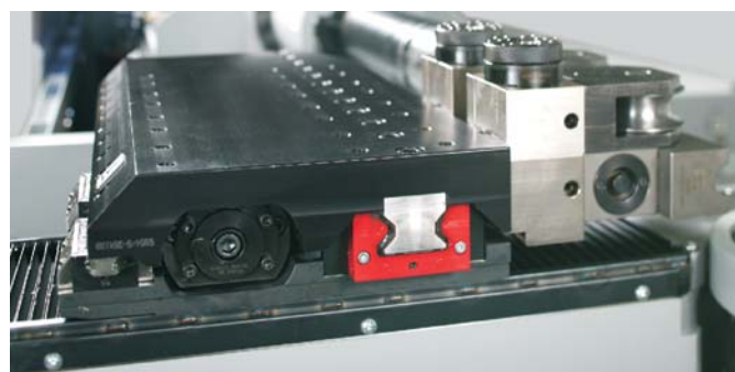
▲ 配备附加导轨的导辊
